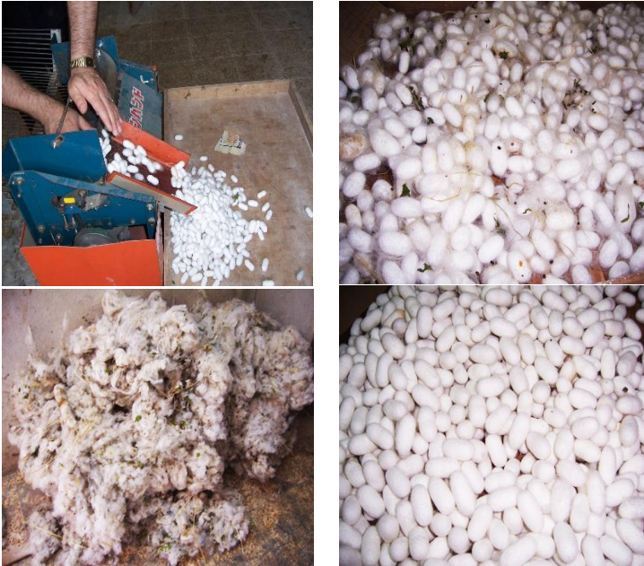
شکل ۵۴. مراحل مختلف کرک‌گیری از پيله با استفاده از دستگاه مخصوص کرک‌گیری
