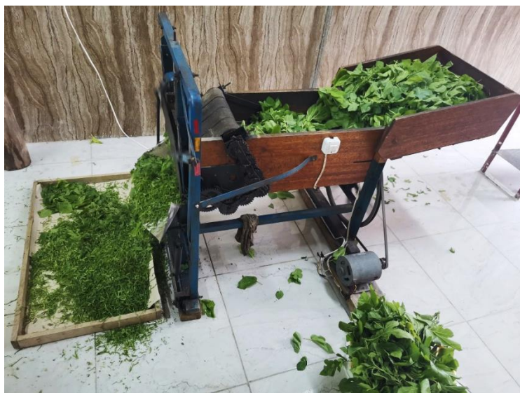
شکل ۳۱. دستگاه برگ خرد کن جهت استفاده در دوره کرم جوان
