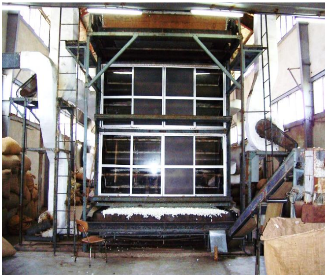
شکل ۵۵. دستگاه مخصوص خشک کردن پیله (سیگاتور)
